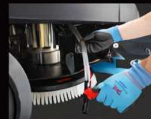
Acceso a válvula de drenaje
