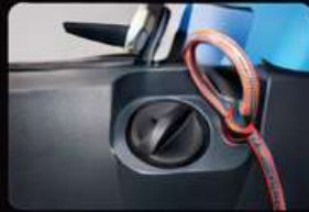
Manguera de drenaje
